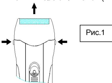
2. Аккуратно извлеките бреющую сетку из внешнего бреющего блока с помощью отвертки.
