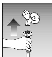
В данную стиральную машину подается только холодная вода. Подключение к водопроводу производится с помощью синего шланга, входящего в комплект поставки.
