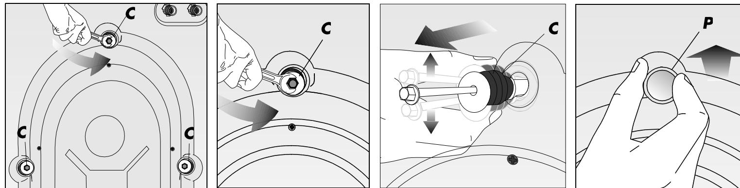
Болты, на головках которых имеется обозначение «**C**» выворачивать против часовой стрелки до тех пор пока они без труда могут быть вытащены.
